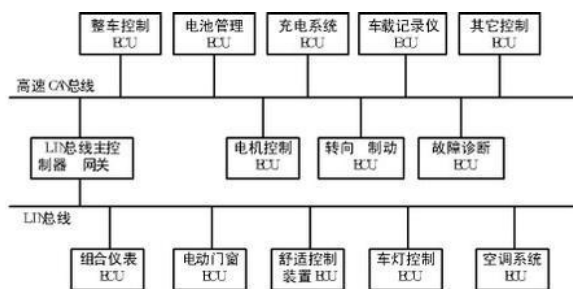
图 2. CAN 总线通信拓扑图
