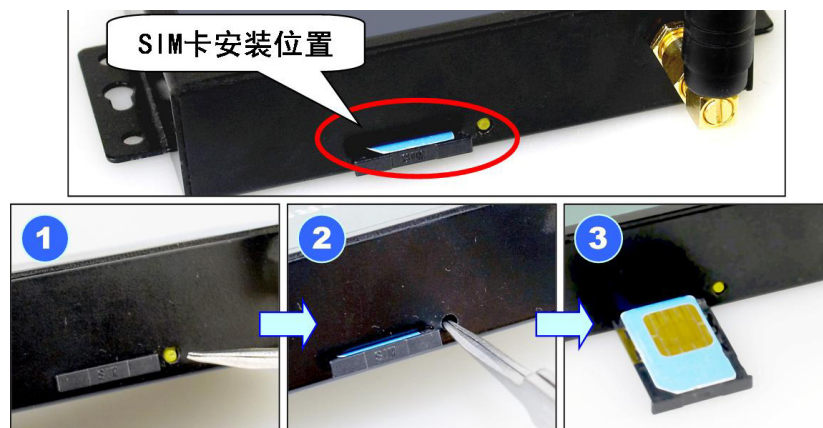
图 2.2 SIM 卡的安装
