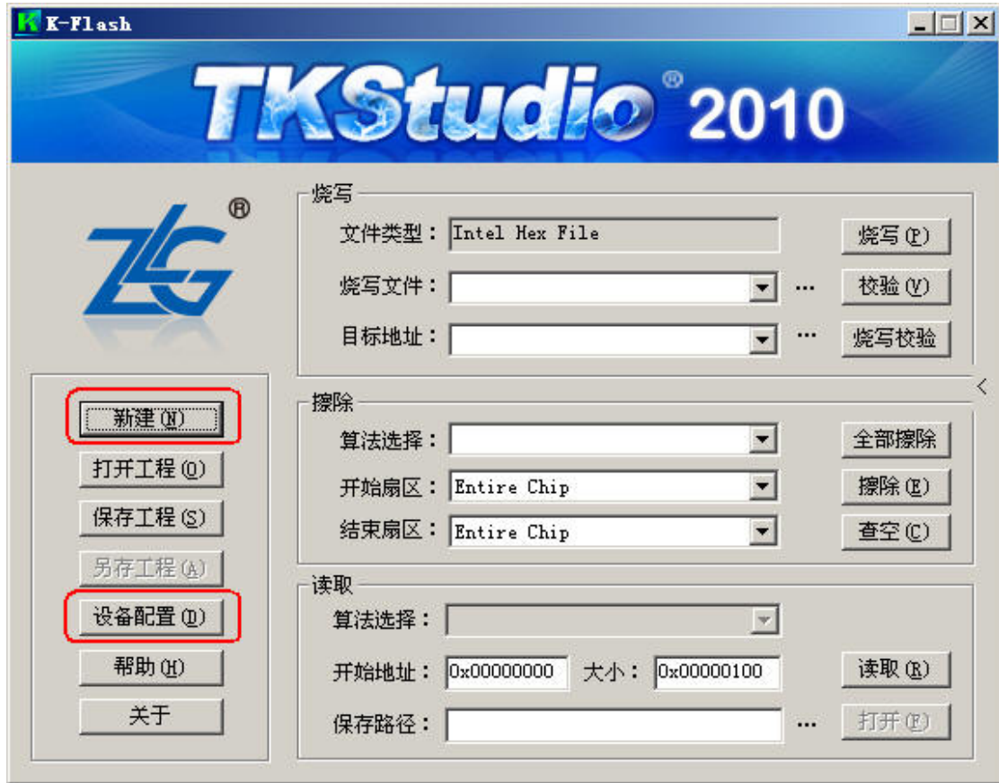
图 2.1 K-Flash 烧写软件界面
