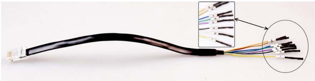
图 3.2 ICP 下载线
