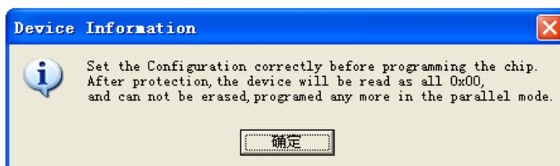
图 2.5 是芯片 R5F212K4SDFP@QFP32 的默认配置信息。Configuration 是芯片配置区。默认是 0xFF。
