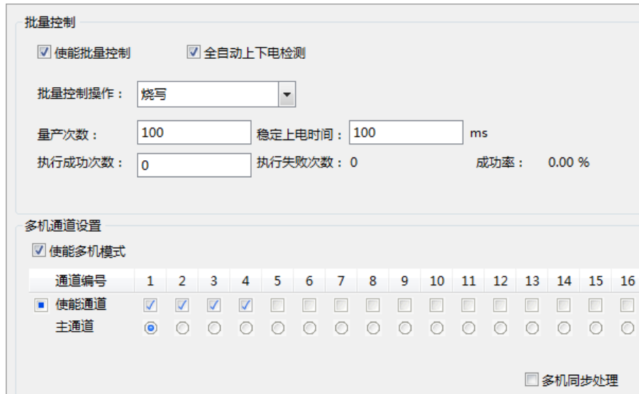
图 5-2 4 路同时烧写配置界面
