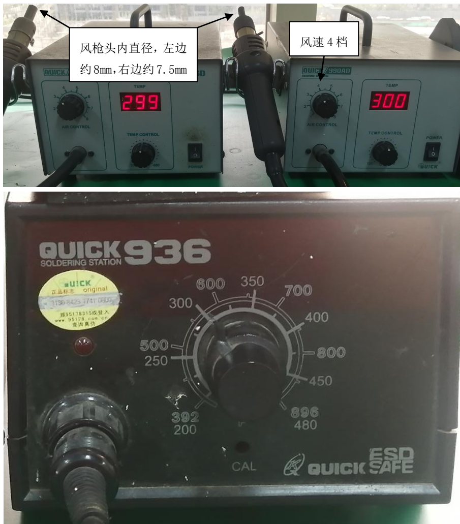
图 2.1 热风枪与电烙铁设置参考
