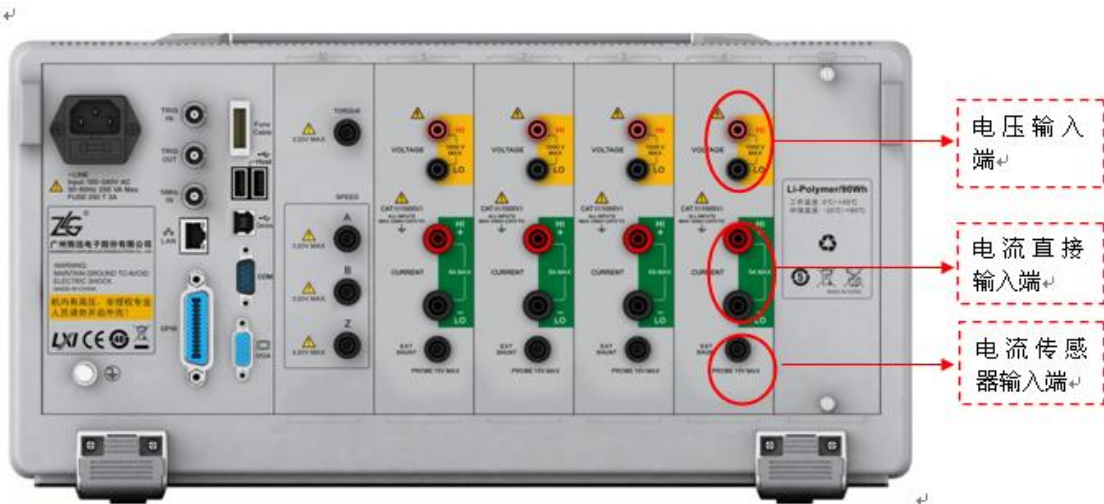
图 2.3 后面板中传感器相关输入端口
