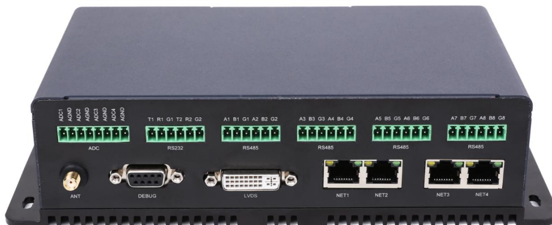
图 2 EM-1000 整机外观后部接口
