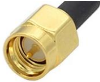
图 9 外接 4G 天线接口需为 SMA 内针
