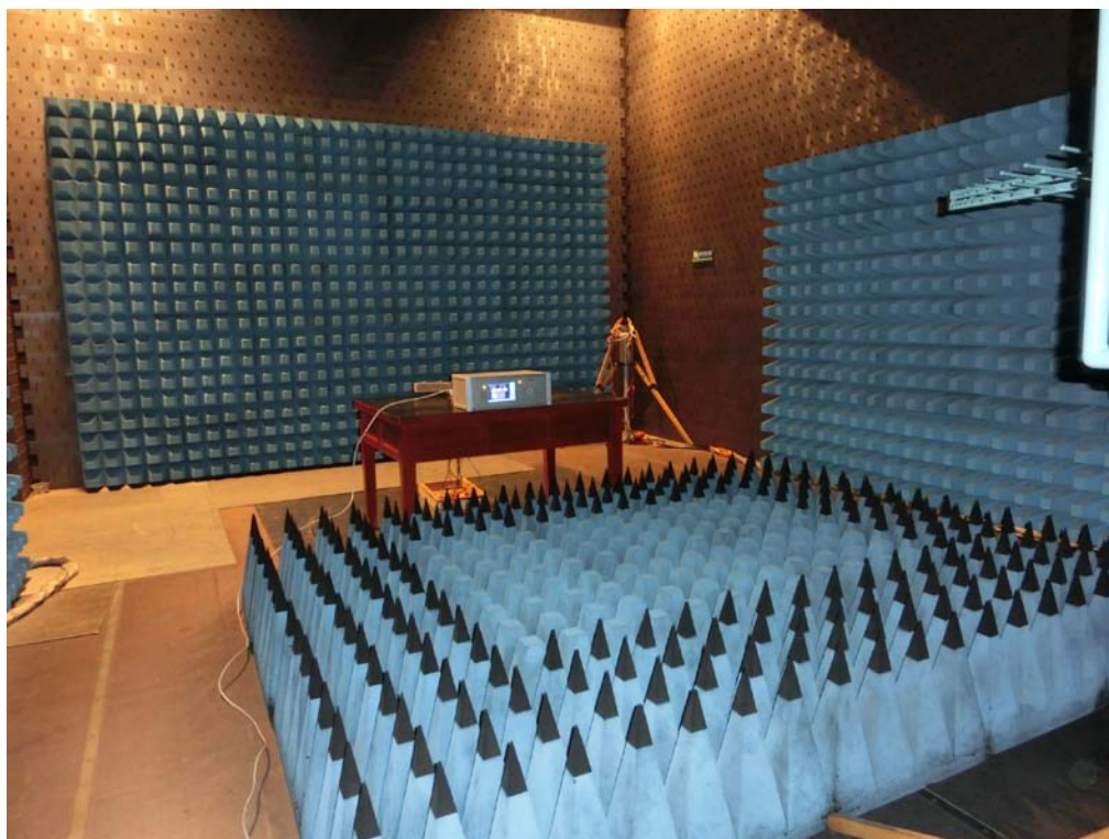
图 3: 射频电磁场辐射抗扰度检验配置图
