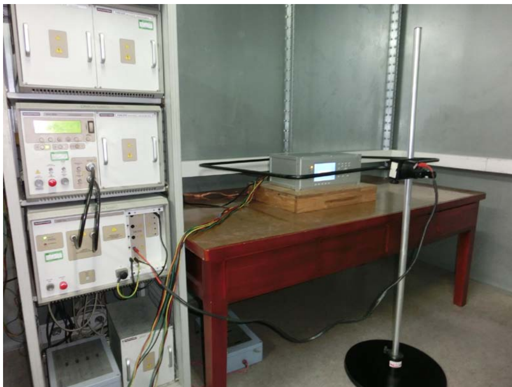
图 7: 脉冲磁场抗扰度检验配置图
