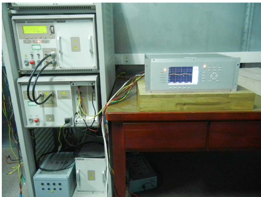
图 1: 阻尼振荡波抗扰度检验配置图
