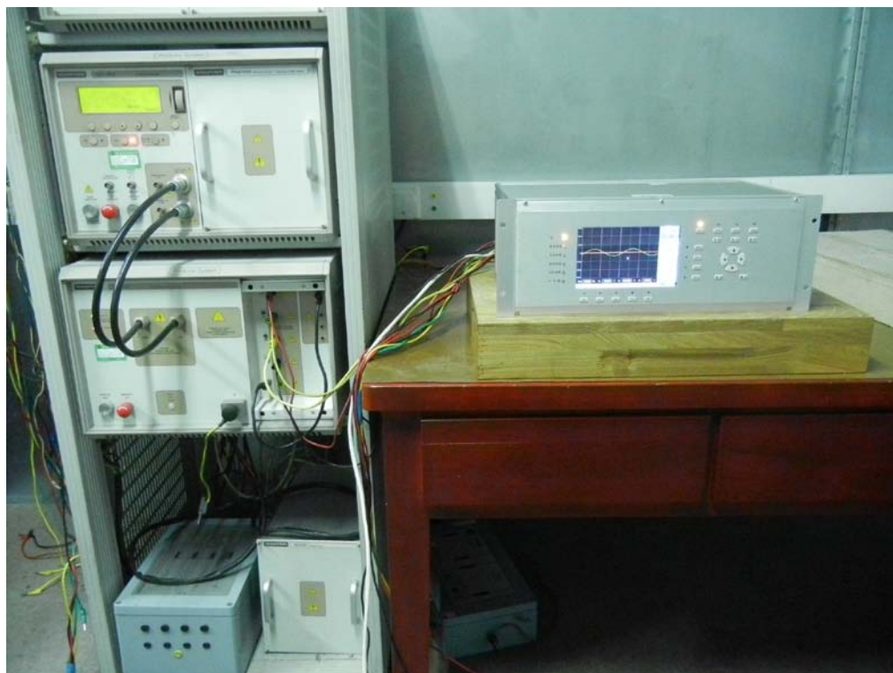
图 5: 浪涌抗扰度检验配置图
