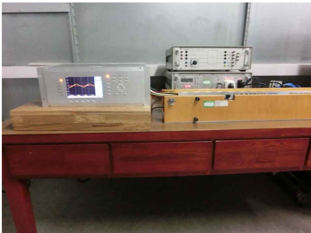
图 4: 电快速瞬变脉冲群抗扰度检验配置图
